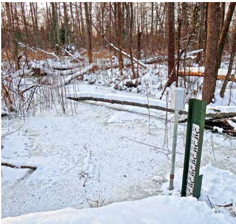
◀ Posterunek limnometryczny i wodowskaz w korycie Siroty (fot. M. Karczewska)
